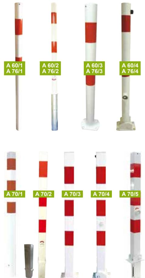
Gesamtlänge der Pfosten zum Einbetonieren 1300 mm, davon 1000 mm über Flur. (/1). Herausnehmbare Pfosten sind 1000 mm über Flur (/2). Bei feststehenden Pfosten mit Fußplatte beträgt die Gesamtlänge 1000 mm (/3). Klappbare Pfosten A 60/4 und A76/4 900 mm über Flur. Klappbare Pfosten A 70/4 und A 70/5 1000 mm über Flur.
